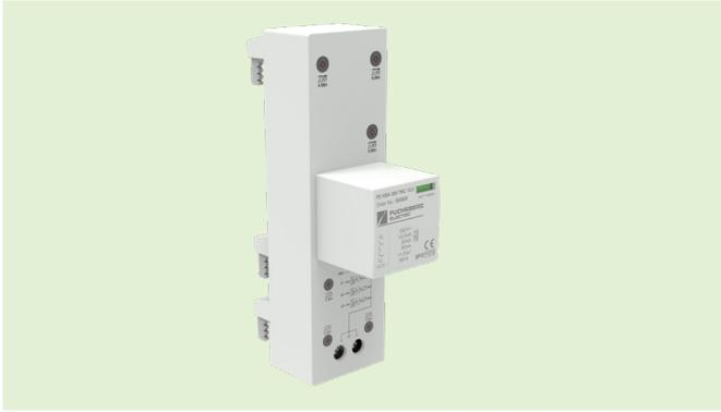
Kombi-Ableiter für Blitzströme Typ 1+2 zur Montage auf 40 mm Sammelschienensysteme wird in 3-phasigen Netzsystemen nach Blitzschutzklasse III und IV mit direkter Kontaktierung über sichere Schraubenverbindungen installiert.
