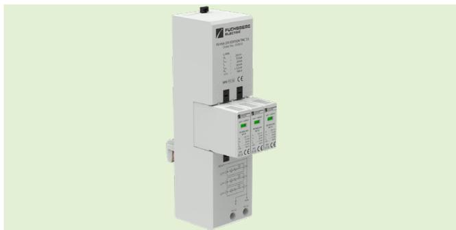
Kombi-Ableiter für Blitzströme Typ1+2 zur Montage auf 40 mm Sammelschienensysteme wird in 3-phasigen Netzsystemen nach Blitzschutzklasse III und IV durch einfaches Aufrasten auf das Schienensystem installiert.
